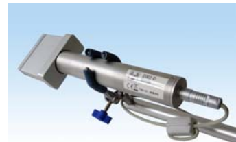
Abb. 3: Befestigungsklammer mit NaJ-Szintillationssonde 2002
