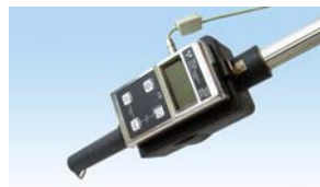
Abb. 4: Geräteaufnahme für das Dosisleistungsmessgerät „X 5 C plus“ am Teleskopadapter
