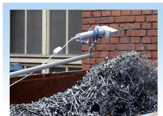
Abb. 1: Teleskopadapter mit NaJ-Szintillationssonde 2002 zur Kontrolle von Stahlschrott auf radioaktive Kontamination
