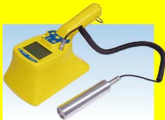
CoMo mit angeschlossenem Detektor zur Dosisleistungsmessung
