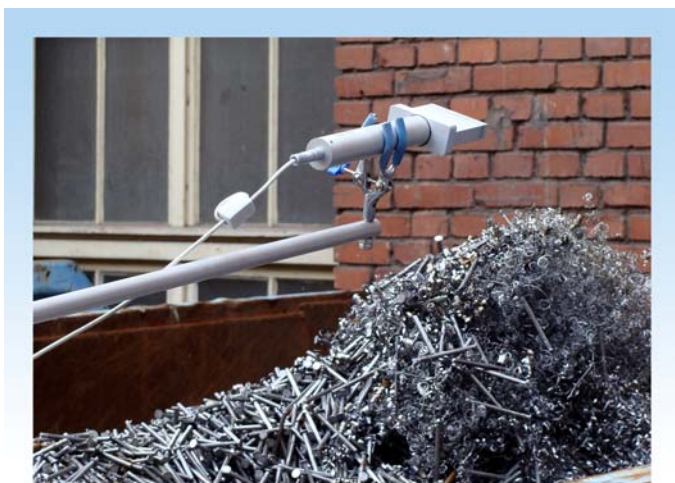
Teleskopadapter mit Nal-Szintillationssonde 2002 D zur Kontrolle von Stahlschrott auf radioaktive Kontamination
